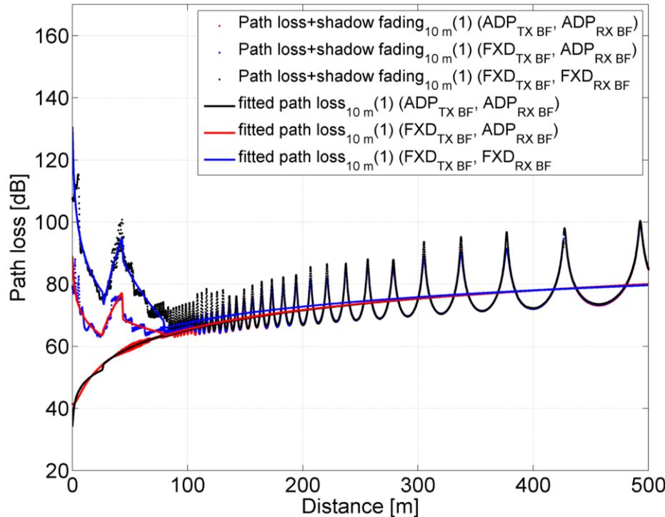
$$L(d) = \bar{L}(d_0) + 10n \lg\left(\frac{d}{d_0}\right) + X_\sigma$$
