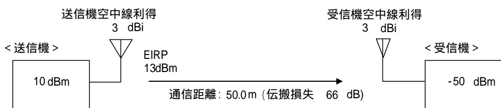
図 参 2-3 空中線電力 10mW における干渉波を考慮した最小の通信距離
